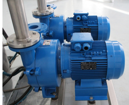
Vakum Sistemi ve Vakum Pompası
